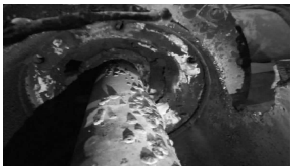
图 3 绝缘子及残留导电杆示意图
