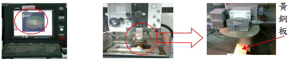
線切割機加工路線模擬 ⇒ 黃銅板安裝於線切割機 ⇒ 線切割機切割雙極板
