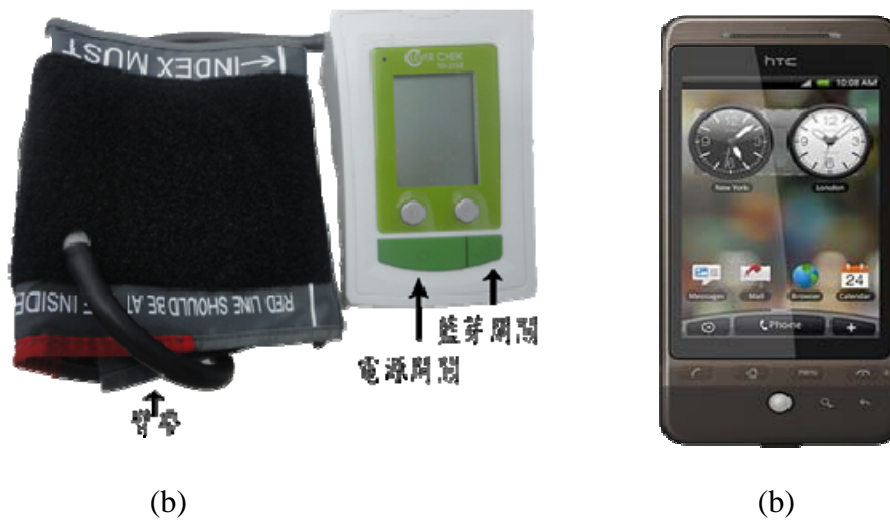
圖五 用戶端所用硬體設備 (a)藍芽血糖血壓計 (b)HTC hero 手機
