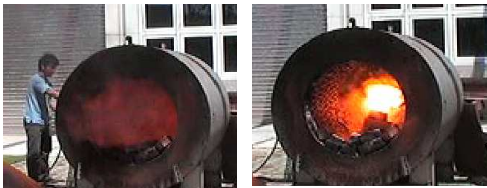
圖 6 比較純重油燃燒與加入氫氧氣之火焰變化
